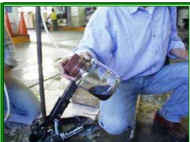
測漏管抽取到浮油
